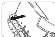
⚠ Vérifiez si l'abattant lavant bouge de droite à gauche. S'il bouge, serrez encore les écrous de fixation.
