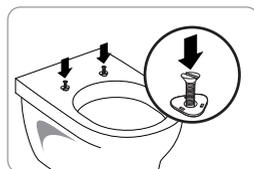
4. Positionnez la platine de clipsage, les 2 coulisses, les 2 plaquettes chanfreinées au-dessus des chevilles à bascule.
