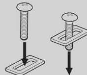
3. Insérer les vis de fixation et leurs glissières dans la platine de fixation.
