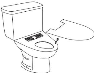
6. Installer le produit : faites coïncider le dormant arrière de l'abattant avec la platine de fixation puis faites le coulisser sur la céramique d'avant en arrière. L'abattant doit se clipser sur la platine et prendre sa position finale.
