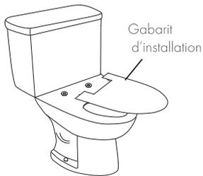
4. Fixer la platine de fixation : ajuster sa position pour connecter les chevilles expansives et glissières de fixation. Faire entrer les vis dans les chevilles puis fixer la platine de fixation.
